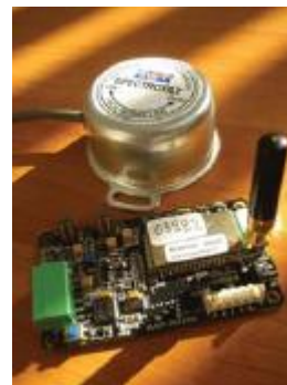
傾斜センサー付きMeshBeamボード
