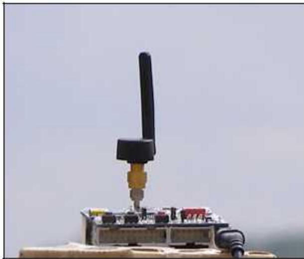
図 2 三脚台の上に搭載した外部アンテナ付の受信モジュール
